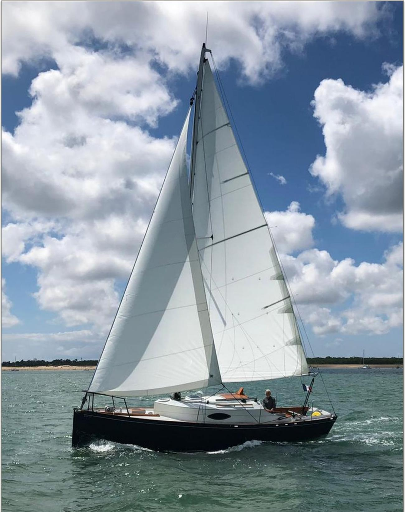
grand'voile, foc bordé assez fort pour équilibrer le bateau. Gîte d'une dizaine de degrés calé sur le bouchain. Aucune intervention sinon regarder les phosphorescences du sillage.
