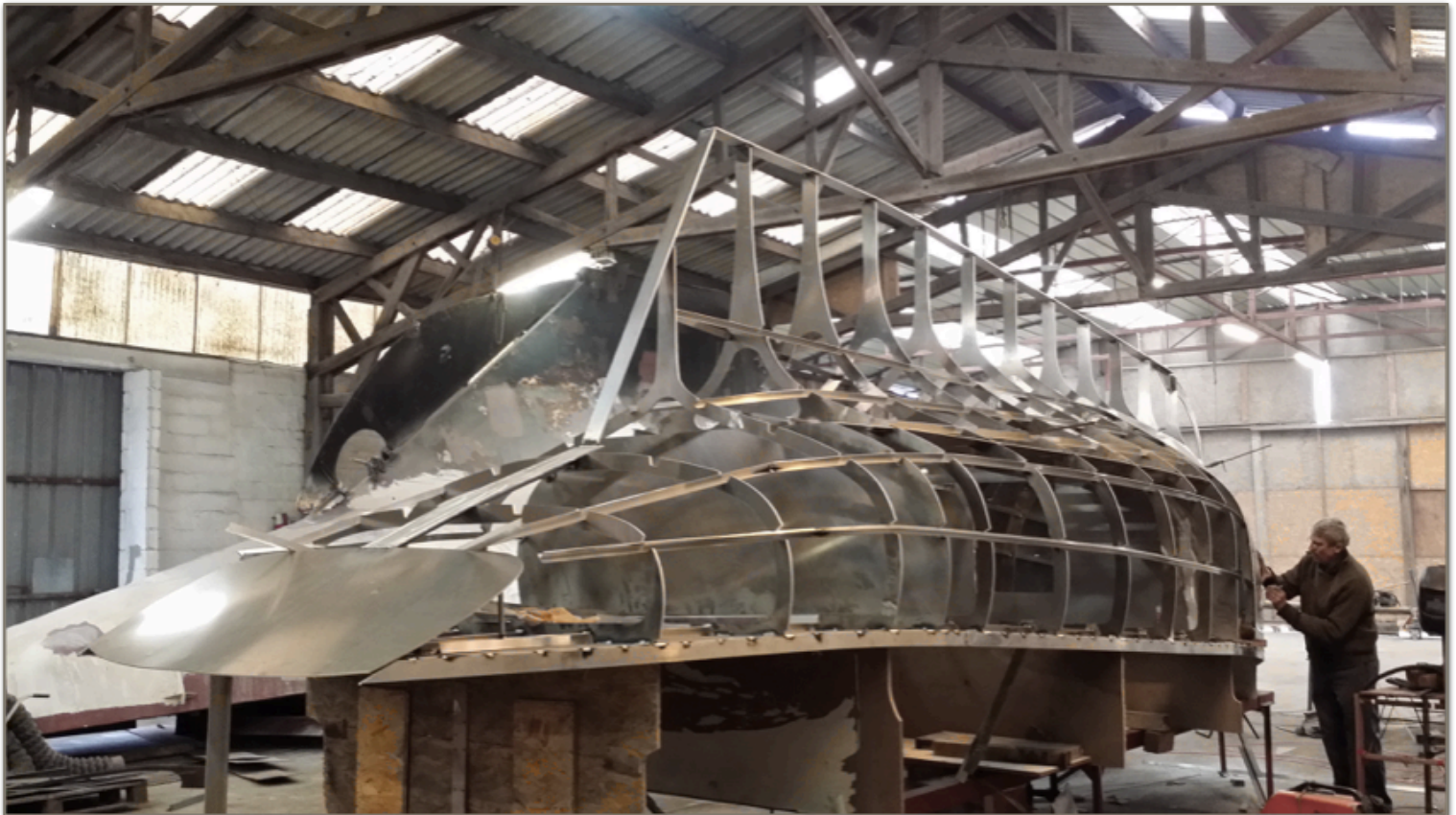
La réplique de Roscovite en construction au chantier Laïta Sailing
